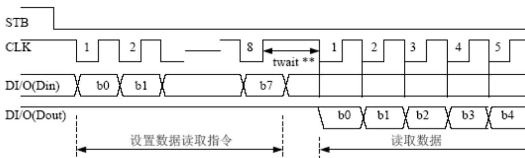
因为 DI/O 管脚为 N 管开漏输出，所以该脚要连接一个外部上拉电阻（1K $\Omega$  到 10K $\Omega$ ）
