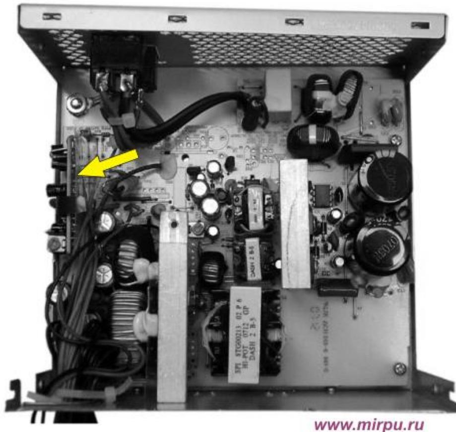
**Рис.4 Блок питания с сбмодулем FSP3528**
